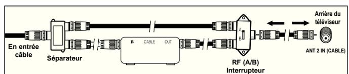
Une fois les branchements effectués, régler le commutateur A/B à la position A pour un visionnement normal. Régler le commutateur A/B à la position B pour obtenir les canaux brouillés. (Lorsque la position B du commutateur A/B est sélectionnée, il faut également syntoniser la chaîne du signal de sortie du câblodistributeur, habituellement la chaîne 3 ou 4.)
