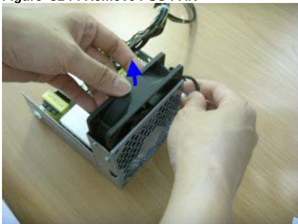
Figure 31 : : Remove PSU FAN
