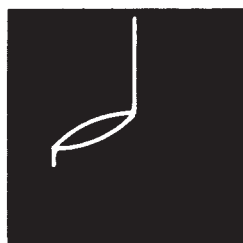
Strecke B-E mit 1 \mu\text{F} + 680 \Omega
