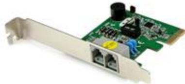
Il modem dati fax 56 K V.92 PCI Express PEX56KIM permette di aggiungere un modem interno per l'accesso a Internet su linea commutata e il supporto della funzione fax al computer attraverso uno slot PCI Express x1 (o superiore) disponibile.
