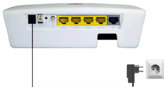
Verbinden Sie das Alice IAD WLAN 4421 mit dem Stromnetz.
