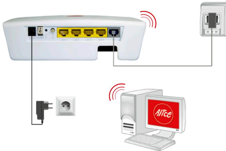
Verbinden Sie das Alice IAD WLAN 4421 mit der Telefondose.
