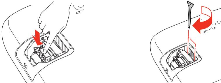
9. Vuelva a colocar la tapa. (El proyector no funcionará si la tapa de la lámpara está abierta o suelta).
