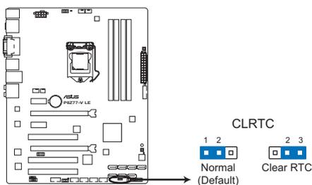
Jumper d'effacement de la mémoire CMOS de la P8Z77-V LE
