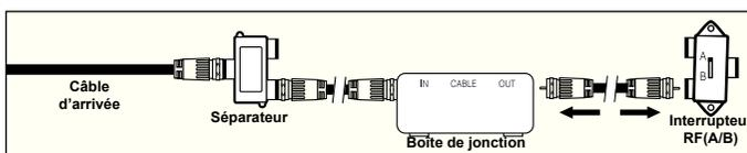
5. Branchez un autre câble entre l'autre prise OUT du séparateur et la prise A.IN de l'interrupteur RF (A/B).
