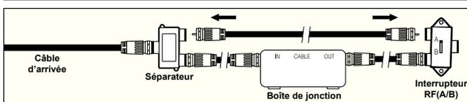
6. Connectez le dernier câble RF entre la borne OUT du commutateur RF (A/B) et la borne ANT IN située à l'arrière du téléviseur.
