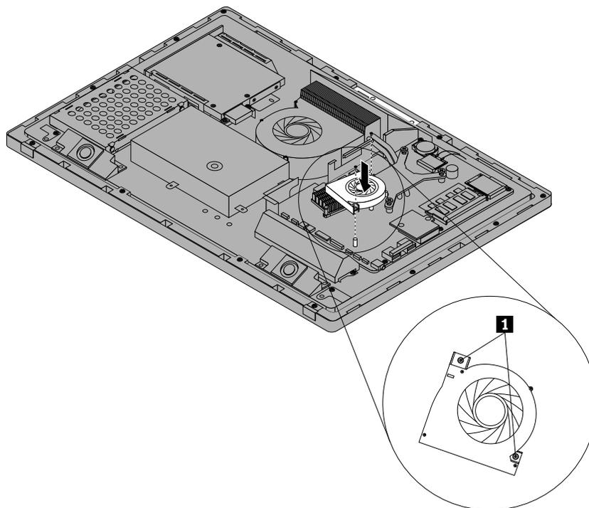
Figure 45. Installing the GPU fan
