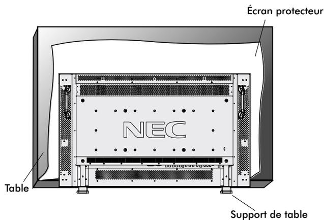
Pour éviter d'endommager la face de l'écran, placez l'écran protecteur sur la table sous l'LCD. L'écran protecteur était enveloppé autour de l'LCD dans l'emballage d'origine. Assurez-vous qu'aucun élément sur la table ne puisse endommager le moniteur.
