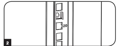
**3** Enfoncez légèrement l'écrou à cage sur les côtés pour permettre à la bride restante de passer dans l'ouverture carrée. Lorsque l'écrou à cage est correctement installé, les deux brides sortiront par l'ouverture carrée et seront visibles sur la surface extérieure du rail de montage. Répétez les étapes 1 à 3 jusqu'à ce que les écrous à cage soient installés.
