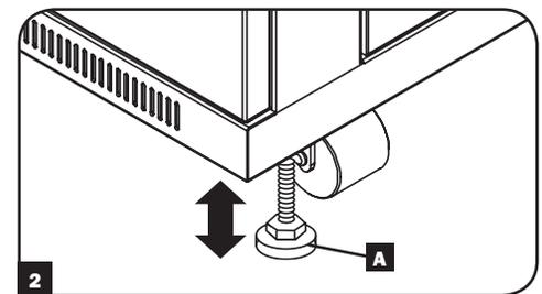
**3** Después de bajar cada nivelador, use el nivel de carpintero para confirmar que el rack está nivelado en todas las direcciones. Ajuste los niveladores hasta que el rack esté nivelado.
