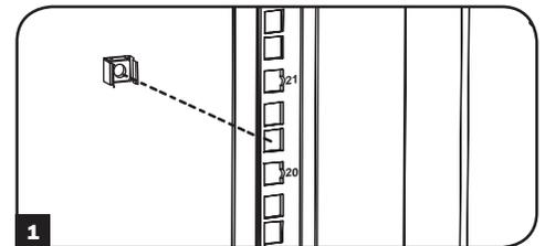
**2** Desde adentro del riel de montaje, inserte una de las bridas de la tuerca en jaula a través de la abertura cuadrada. Presiónela contra el lado de la abertura cuadrada. Cada brida debe engancharse en un lado de la abertura cuadrada, ni arriba ni abajo.
