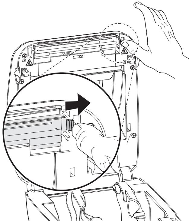
2. Tirez la tête vers l'avant et dégagez-la du boîtier supérieur si nécessaire.
