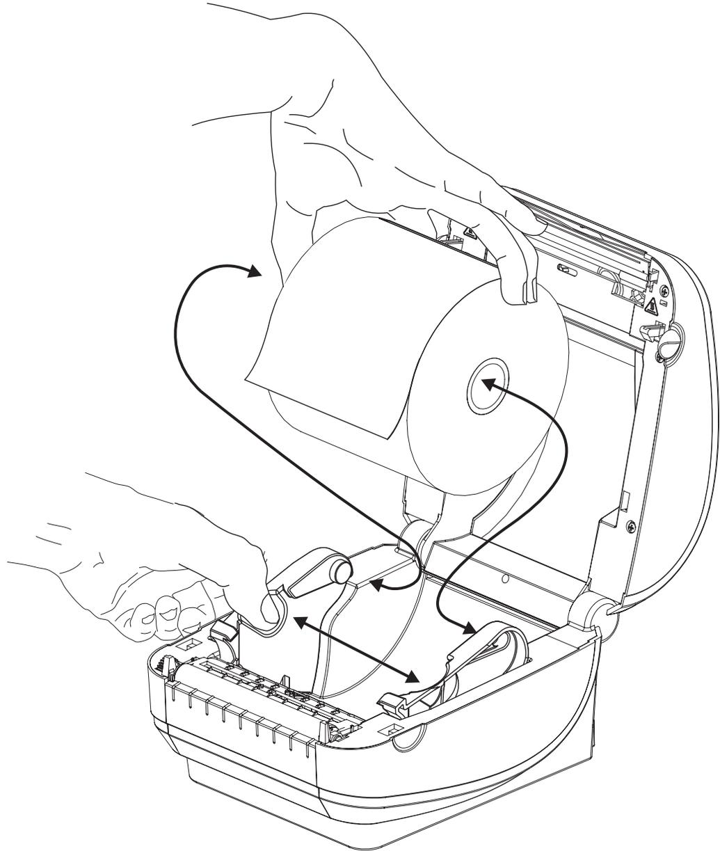
3. Tirez sur le papier pour en dérouler une longueur à l'avant de l'imprimante. Assurez-vous que le rouleau tourne librement. Le rouleau ne doit pas être posé au fond du compartiment papier. Assurez-vous que la surface imprimable du papier est orientée vers le haut.
