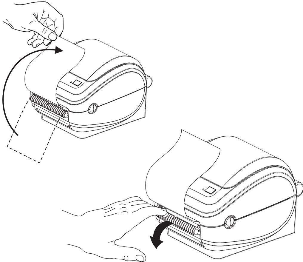
3. Insérez le support d'étiquettes entre la porte de distribution et le corps de l'imprimante.
