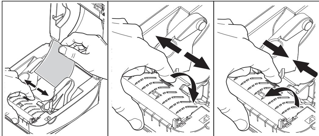
3. Insérez le papier dans la fente à l'arrière de l'imprimante.
