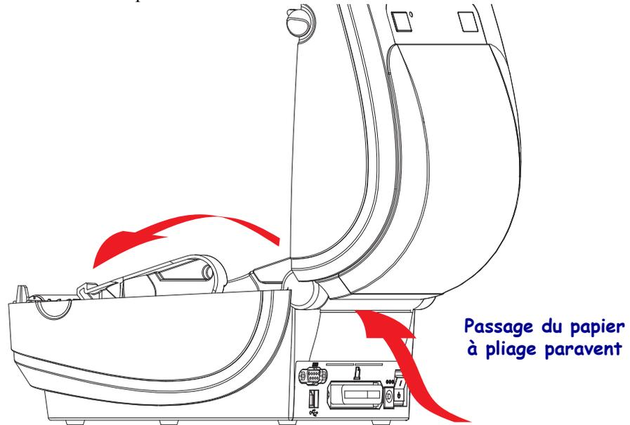
2. Réglez la position d'arrêt du guide de papier à l'aide de la molette verte. À l'aide d'un morceau de papier à pliage paravent, réglez la position d'arrêt. Faites tourner la roue vers vous pour élargir l'ouverture des guides ou en l'éloignant de vous pour la rétrécir.
