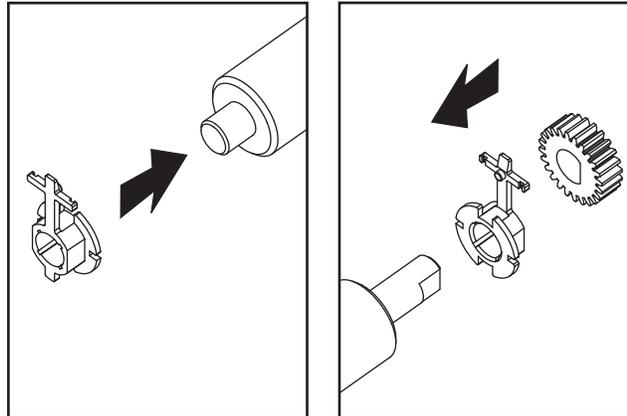
7. Alignez le contre-rouleau avec l'ergot sur la gauche et remettez-le en place dans le bâti inférieur de l'imprimante.
