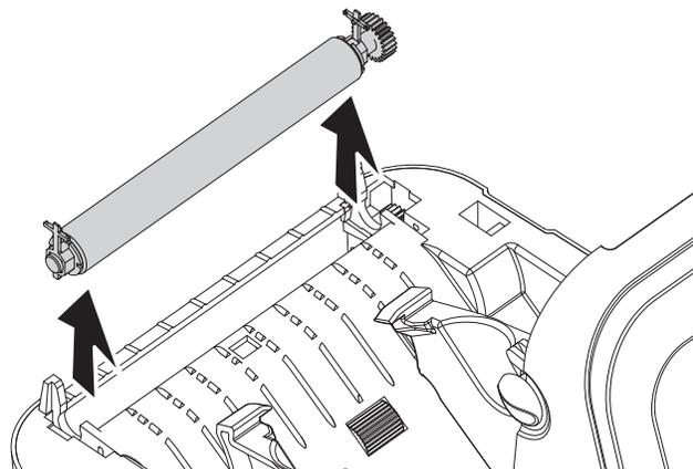
4. Nettoyez le contre-rouleau à l'aide d'un tampon imbibé d'alcool. Nettoyez du centre vers l'extérieur. Répétez l'opération jusqu'à ce que la surface du rouleau ait été entièrement nettoyée. En cas de forte accumulation de matière adhésive ou de bourrage d'étiquettes, répétez l'opération avec un tampon neuf pour supprimer toute impureté résiduelle. En effet, le nettoyage initial ne suffit pas à supprimer complètement les matières adhésives et les corps gras.
