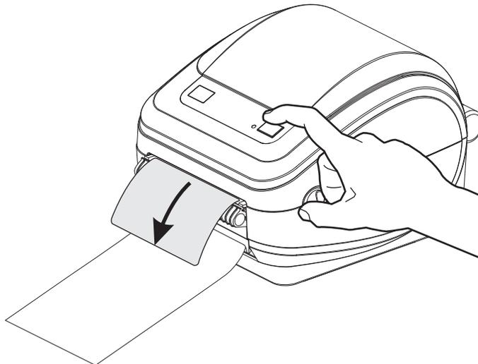
6. Pendant le travail d'impression, l'imprimante décolle le support et présente une seule étiquette. Ôtez l'étiquette de l'imprimante pour lui permettre d'imprimer la suivante. Remarque : si vous n'avez pas activé la cellule Étiquette prise pour détecter le prélèvement de l'étiquette distribuée (décollée) au moyen de commandes logicielles, l'imprimante empile et éjecte les étiquettes décollées.
