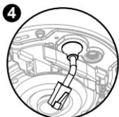
4. Remova o plugue de borracha para vedação da câmera de base. Em seguida alimente o cabo Ethernet a partir da parte inferior da câmera e aperte o plugue de borracha para vedação para impermeabilizá-lo.
