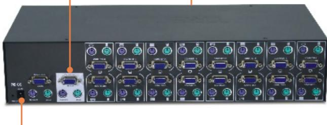
4. Verbinden Sie den beiliegenden Stromadapter mit dem KVM-Umschalter und stecken Sie ihn in eine Steckdose.
