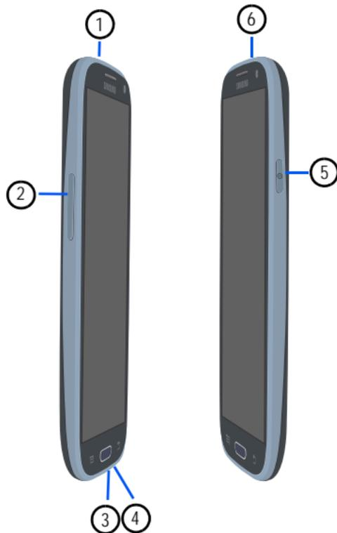
1. **Prise pour écouteur** : permet de brancher un casque d'écoute de 3,5 mm.
