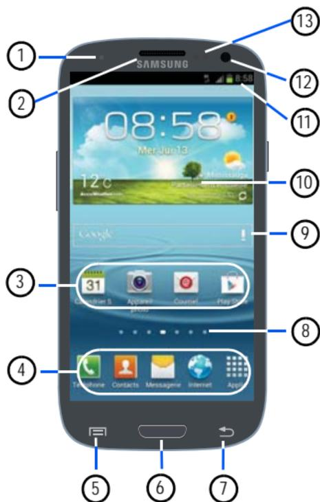
1. **Voyant d'état** : apparaît rouge lors du chargement de la pile, vert lorsque la pile est pleine, bleu lorsque l'appareil s'allume et orange lors d'une notification.
