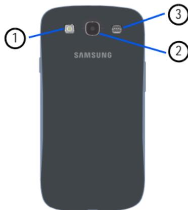
1. **Flash** : élément de l'appareil photo, permet de fournir une source de lumière additionnelle dans des conditions de faible éclairage.
