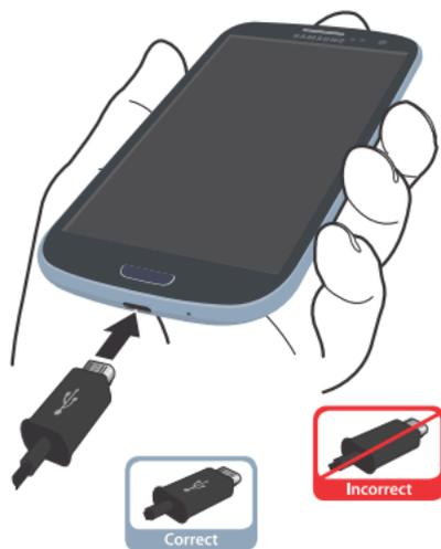
1. Branchez la petite extrémité du chargeur dans la prise multifonction et l'autre fiche dans une prise de courant c.a. ordinaire.
