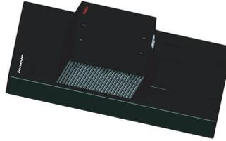
Paso 4: Acople el soporte de montaje incluido en el kit de instalación en pared compatible con VESA (distancia de 100 mm x 100 mm) con los tornillos de instalación VESA M4 x 10 mm.
