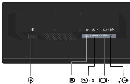
3. Priključite jedan kraj kabela za analogni signal na VGA priključak monitora, a drugi kraj kabela na računalo.
