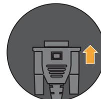
4. Jedan kraj digitalnog kabela spojite na DVI priključak, a drugi kraj spojite na priključak sa stražnje strane računala.
