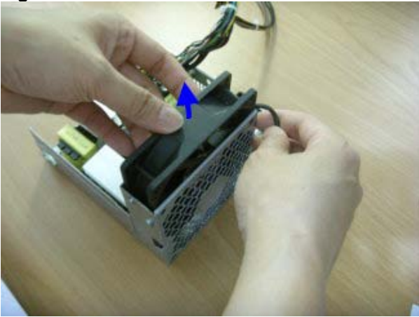
Figure 31 : : Remove PSU FAN
