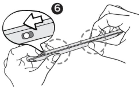
6. 再次從右側往下壓，將背蓋卡入，然後將固定鎖往鎖定位置推到底。
